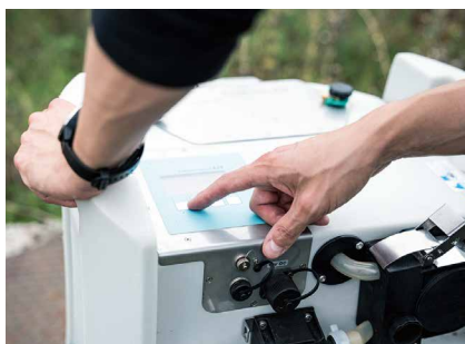
Automaattinen näytekeraäin voidaan ohjelmoida ottamaan haluttu määrä vettä ennalta määritetyin aikavälein.
