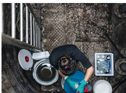
Edeltävän vuorokauden aikana kerätty vesinäyte pullotetaan huoltotasanteella laboratorioanalyysia varten. Eri yhdisteille on omat näytepullonsa.
